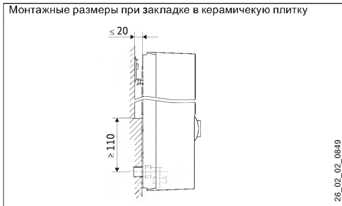
Монтажные размеры при закладке в керамическую плитку
