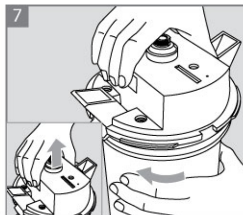
7 把舊濾芯從轉接器拆除。
