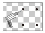
3.1.1 請選擇一幅能承受熱水器的重量 的牆壁或混凝土牆,記下正確的 活工並用合適螺絲固定裝上牆 壁掛架。
