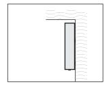
請根據圖示把熱水器垂直安 裝;傾斜度不能大於5度。
