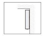
3.1.3 請根據圖示把熱水器垂直 安裝;傾斜度不能大於5 度。
